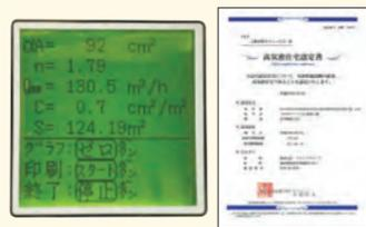
専用の測定器で気密測定を行い、高気密住宅の性能保証をします。
