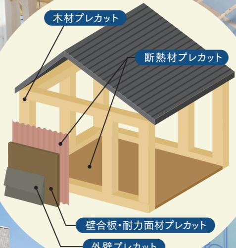
木造住宅を支える骨組みとなる土台、柱、梁などの構造用木材を、工場内の全自動加工機によって加工します。ミリ単位の精度を追求する精密加工によって、高品質で強い木造住宅を生み出します。
